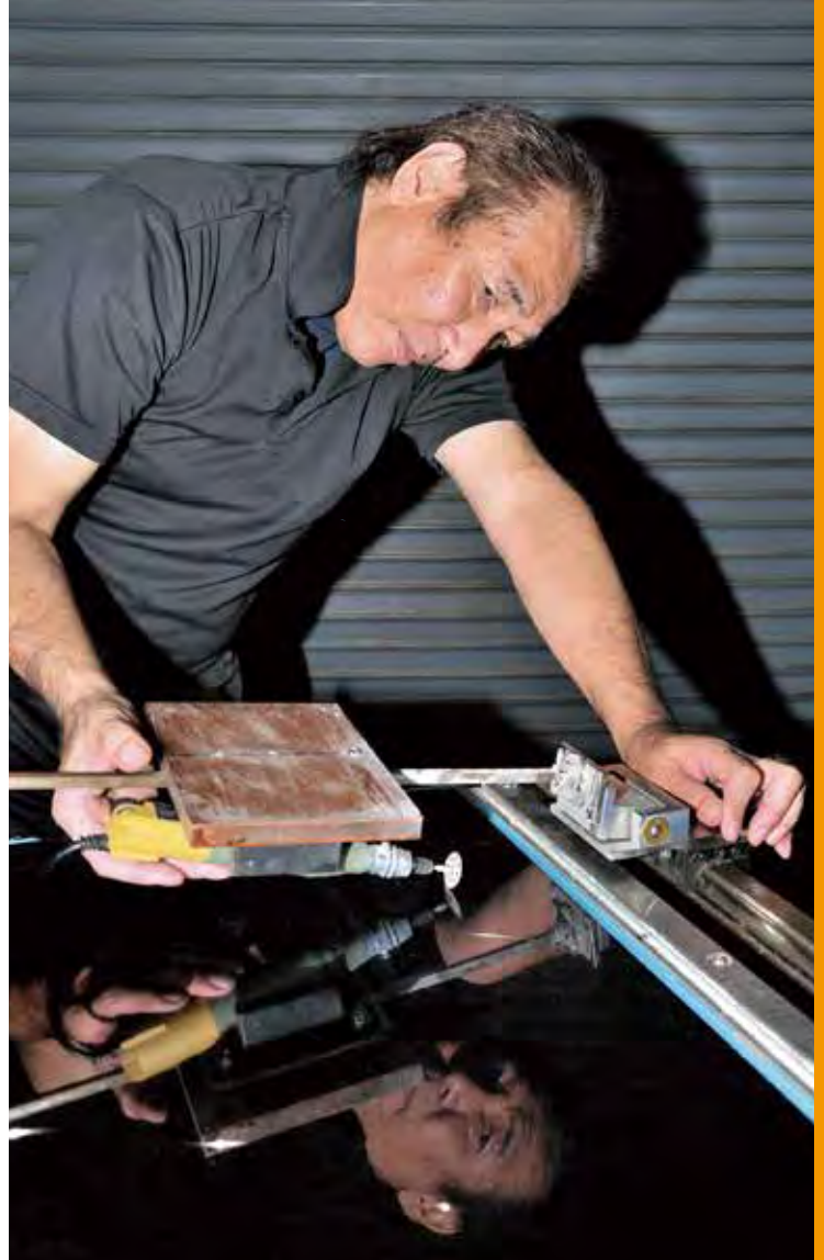
市販のダイヤモンドカッターを手作りの器具に取り付けて 特殊ガラスを切断
