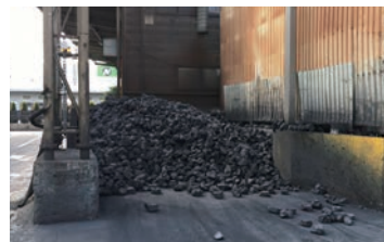
铸物の原材料のひとつであるコークス。ほかの素材と混ざり、鉄に生まれ変わる
